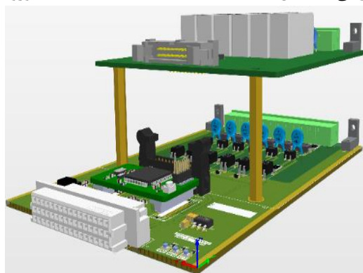
۶ ورودی دیجیتال و ۶ خروجی دیجیتال
