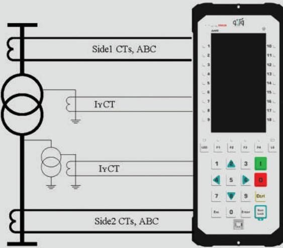
این رله دارای توابع دیفرانسیل، تشخیص جریان هجومی، اتصال زمین محدود شده، اضافه حریک، اضافه جریان، اتصال زمین و ... می باشد. از این رله می توان برای حفاظت ترانسفورماتور قدرت استفاده کرد. رله M121 برای این مورد پیشنهاد می گردد. با توجه به ساختار مازولار رله می توان تعداد ورودی و خروجی های دیجیتال مورد نیاز را افزایش داد.
